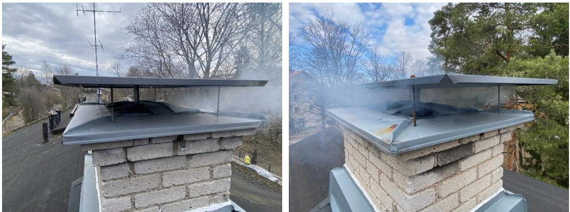
Kuva 22 ja 23. Pääosin merkisavu poistui hormoneja pitkin katolle. Tyynellä ilmalla savu jää "patjaksi" piipun hatun ja hormien väliin. Tämä mahdollistaa ilman kulkeutumisen tietyissä tilanteissa takaisin toista hormia pitkin.
