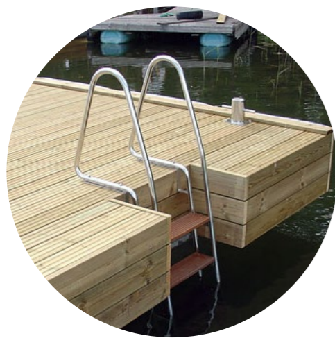
Uimaportaiden koloaminen raskasponttonilaiturin kanteen suojelee portaita jäävoimilta. Kuva: Olli Soininen
